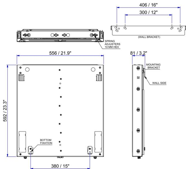
Soporte a suelo para montaje en pared con ajuste de altura manual
